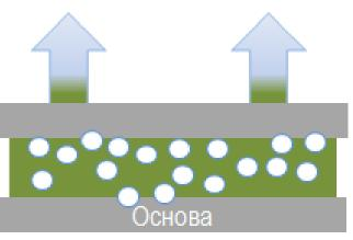
Адгезив формирует максимальную прочность соединения
